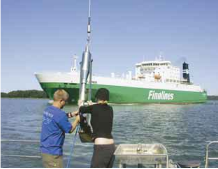
Kuva 2. Sedimenttinäytteet otettiin putkinoutimella, jolla saadaan kerralla noin metrin pituinen sedimenttinäyte. Näytteestä analysoitiin ylin 5 cm. (Kuva: Nina Holmström)
